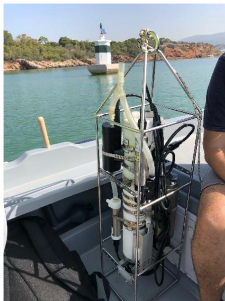
Εικόνα 2: Το νεφελόμετρο προσαρμοσμένο σε αυτογραφικό σύστημα CTD, το οποίο χρησιμοποιήθηκε για τις μετρήσεις στην περιοχή του έργου της Μαρίνας Βουλιαγμένης την 7η Ιουλίου 2021
