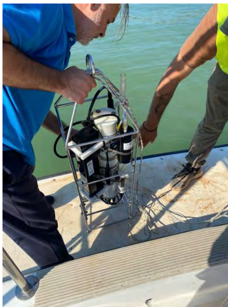
Εικόνα 2: Το νεφελόμετρο προσαρμοσμένο σε αυτογραφικό σύστημα CTD, το οποίο χρησιμοποιήθηκε για τις μετρήσεις στην περιοχή του έργου της Μαρίνας Βουλιαγμένης την 30 η Ιουνίου 2021
