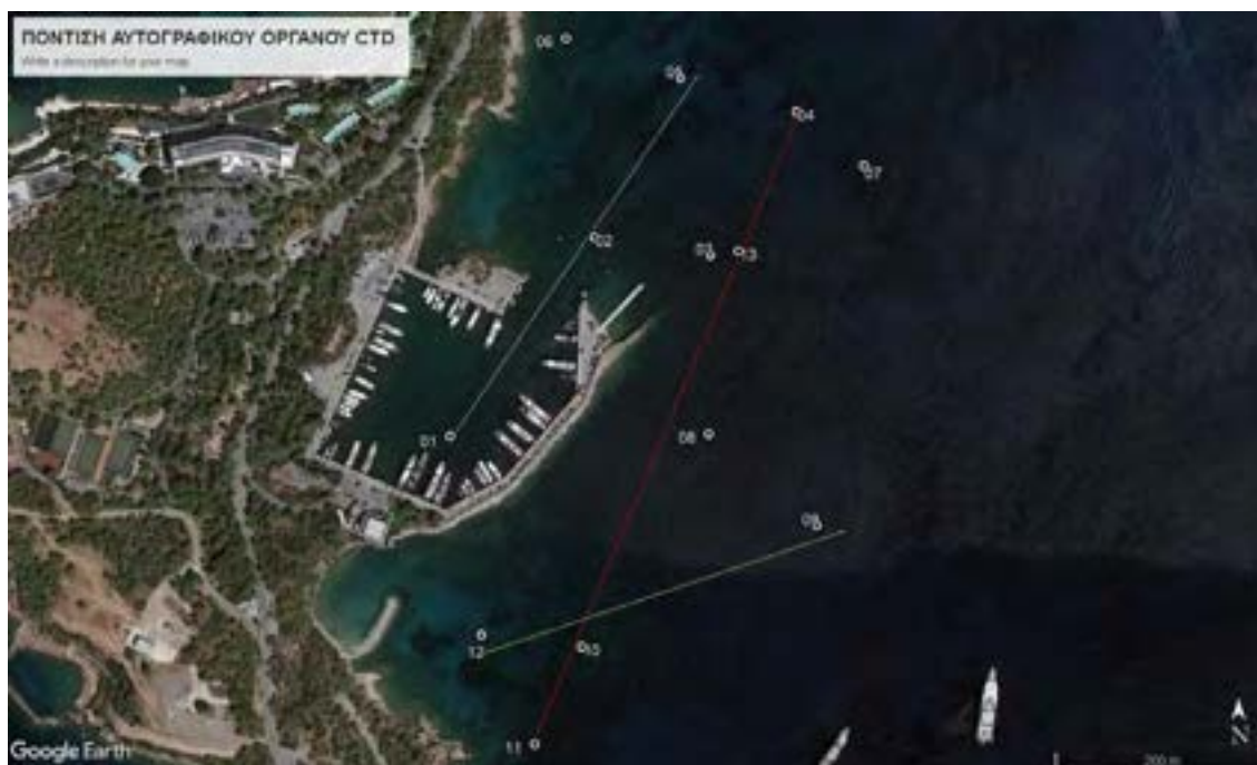
Εικόνα 3: Θέσεις μέτρησης της θολερότητας στην περιοχή του έργου της Μαρίνας Βουλιαγμένης κατά τη διάρκεια της 15 ης Ιουλίου 2021. Η άσπρη, η κόκκινη και η κίτρινη γραμμή αντιπροσωπεύει τη γεωγραφική θέση της τομής της Εικόνας 8α, 8β και 8γ, αντίστοιχα.
