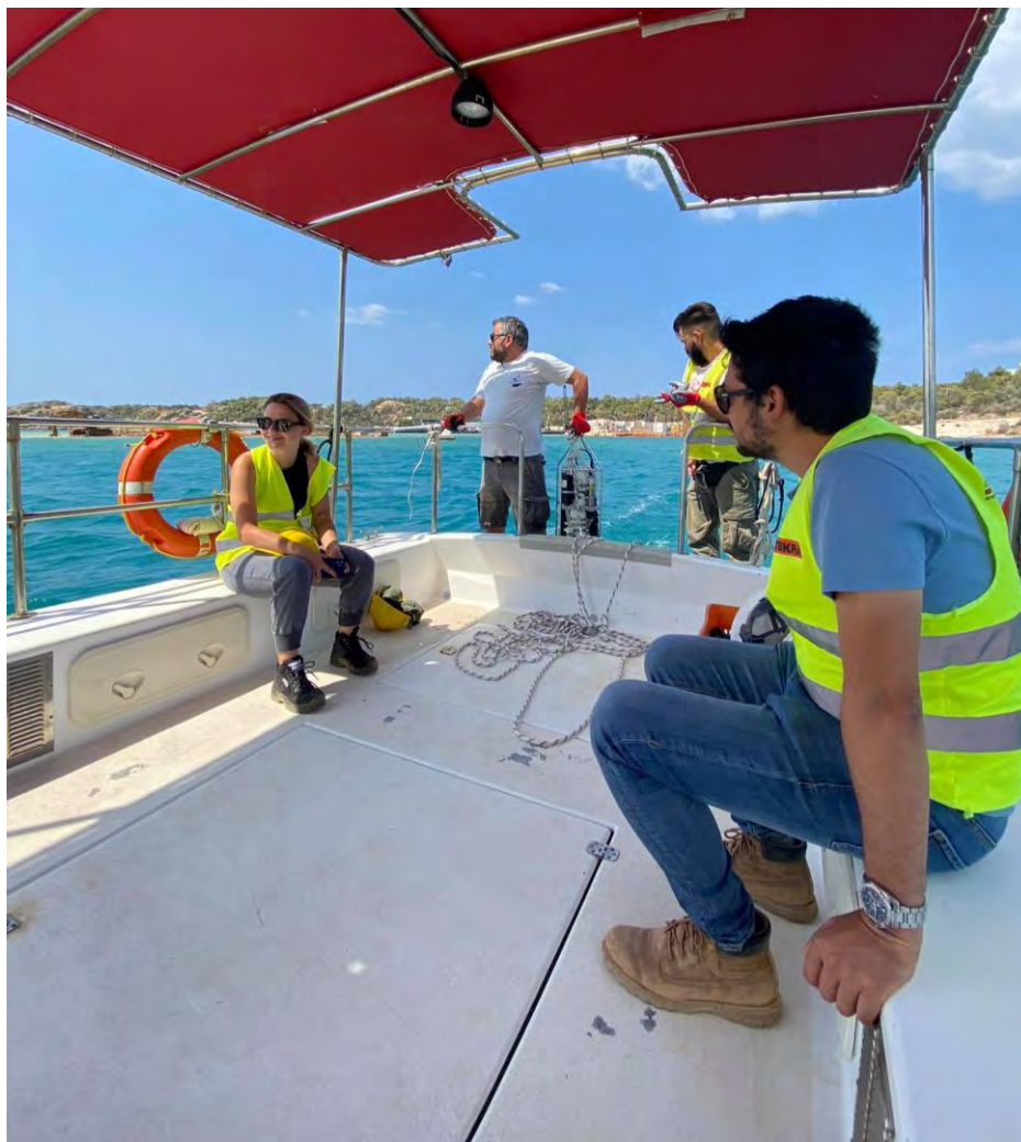
Εικόνα 2: Εργασίες πεδίου με νεφελόμετρο προσαρμοσμένο σε αυτογραφικό σύστημα CTD, το οποίο χρησιμοποιήθηκε για τη συλλογή μετρήσεων στην περιοχή του έργου της Μαρίνας Βουλιαγμένης.
