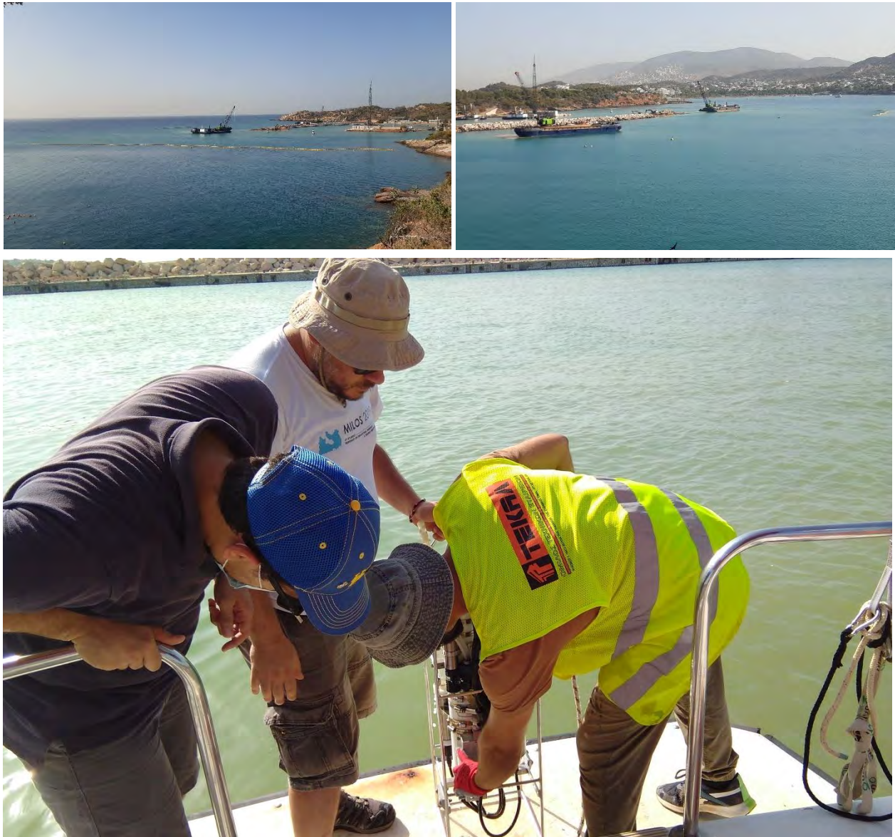
Εικόνα 2: Εργασίες πεδίου με νεφελόμετρο προσαρμοσμένο σε αυτογραφικό σύστημα CTD, το οποίο χρησιμοποιήθηκε για τη συλλογή μετρήσεων στην περιοχή του έργου της Μαρίνας Βουλιαγμένης την 3 η Αυγούστου 2021
