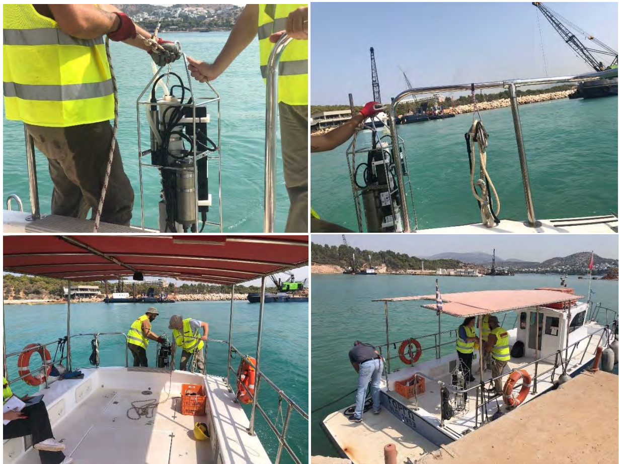
Εικόνα 2: Εργασίες πεδίου με νεφελόμετρο προσαρμοσμένο σε αυτογραφικό σύστημα CTD, το οποίο χρησιμοποιήθηκε για τη συλλογή μετρήσεων στην περιοχή του έργου της Μαρίνας Βουλιαγμένης την 11 η Αυγούστου 2021
