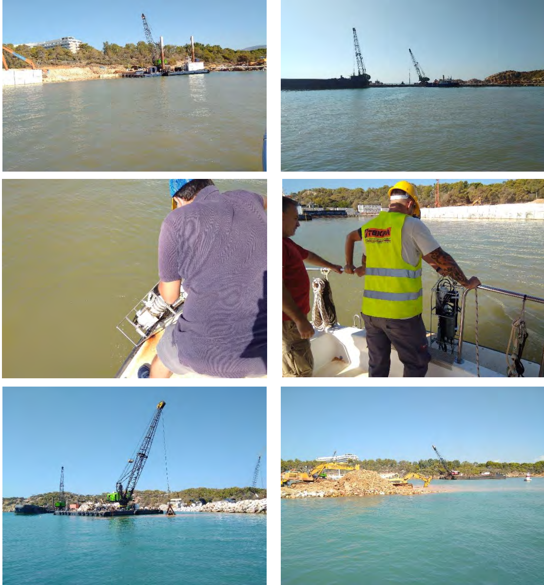
Εικόνα 2: Εργασίες πεδίου με νεφελόμετρο προσαρμοσμένο σε αυτογραφικό σύστημα CTD, το οποίο χρησιμοποιήθηκε για τη συλλογή μετρήσεων στην περιοχή του έργου της Μαρίνας Βουλιαγμένης την 31 η Αυγούστου 2021
