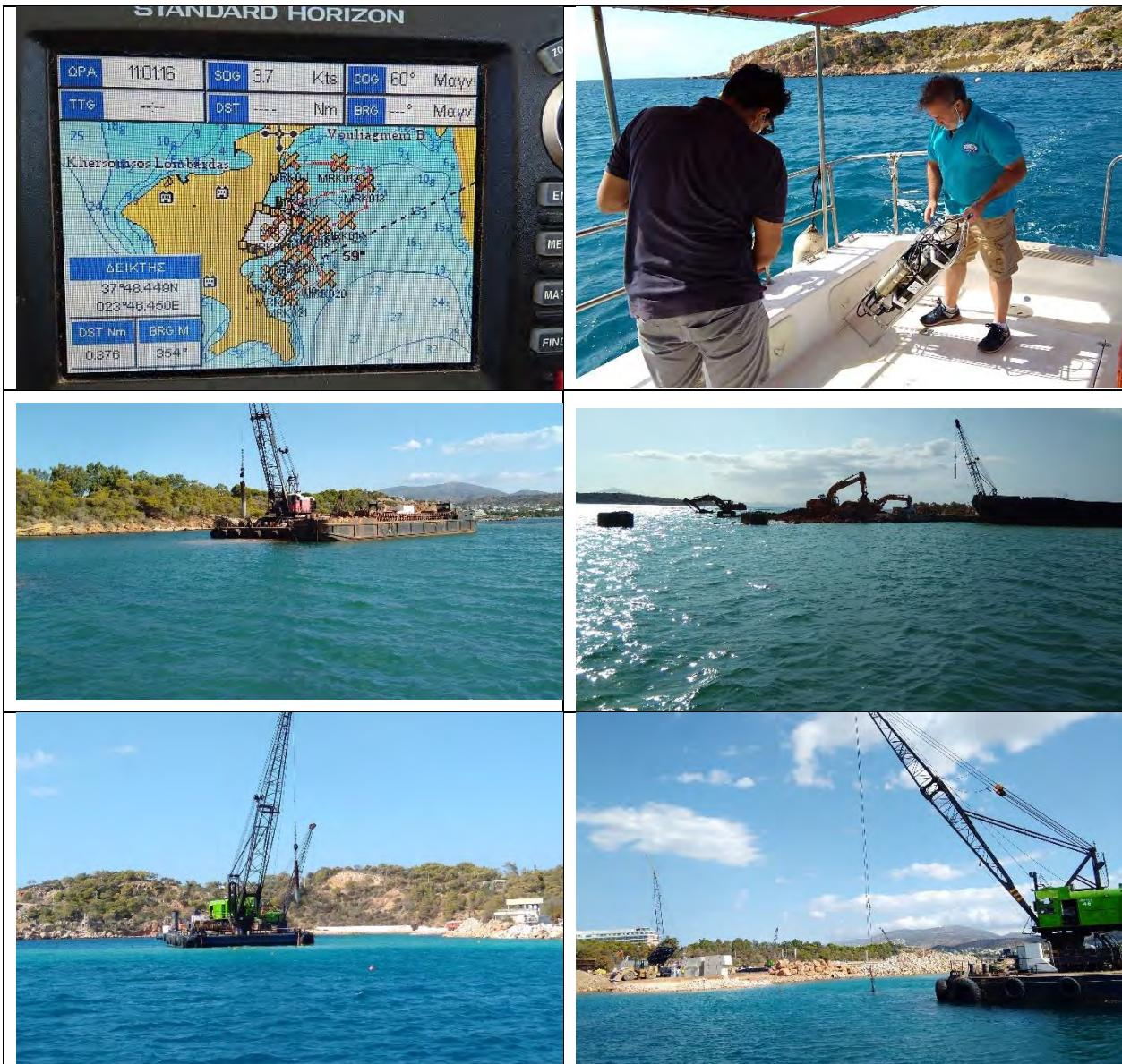
Εικόνα 2: Εργασίες πεδίου με νεφελόμετρο προσαρμοσμένο σε αυτογραφικό σύστημα CTD, το οποίο χρησιμοποιήθηκε για τη συλλογή μετρήσεων στην περιοχή του έργου της Μαρίνας Βουλιαγμένης την 7<sup>η</sup> Σεπτεμβρίου 2021
