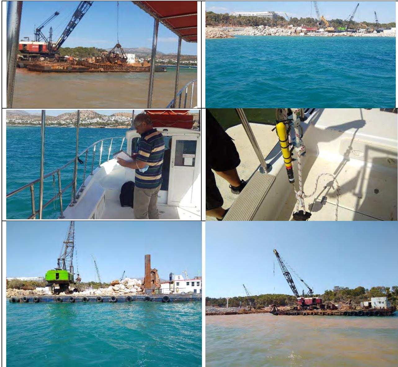
Εικόνα 2: Εργασίες πεδίου με νεφελόμετρο, το οποίο χρησιμοποιήθηκε για τη συλλογή μετρήσεων στην περιοχή του έργου της Μαρίνας Βουλιαγμένης την 29<sup>η</sup> Σεπτεμβρίου 2021
