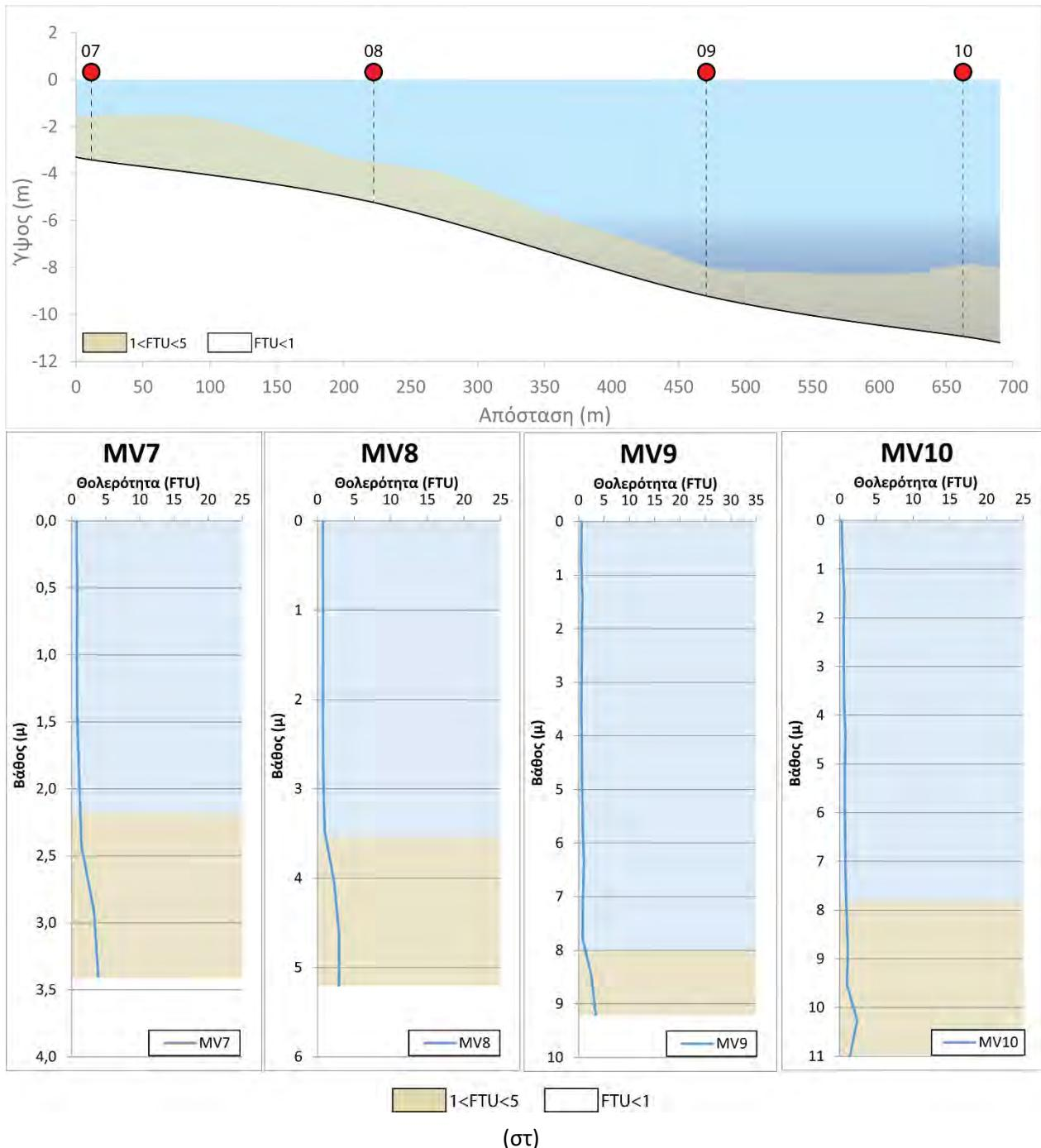
**Εικόνα 6:** Σχηματική αναπαράσταση της διασποράς/διάχυσης του παραγόμενου νεφελώματος από τις εργασίες εκσκαφής/βυθοκόρησης της 4<sup>η</sup> Φεβρουαρίου 2022. Για τις θέσεις των μετρήσεων βλέπε την Εικόνα 3.
