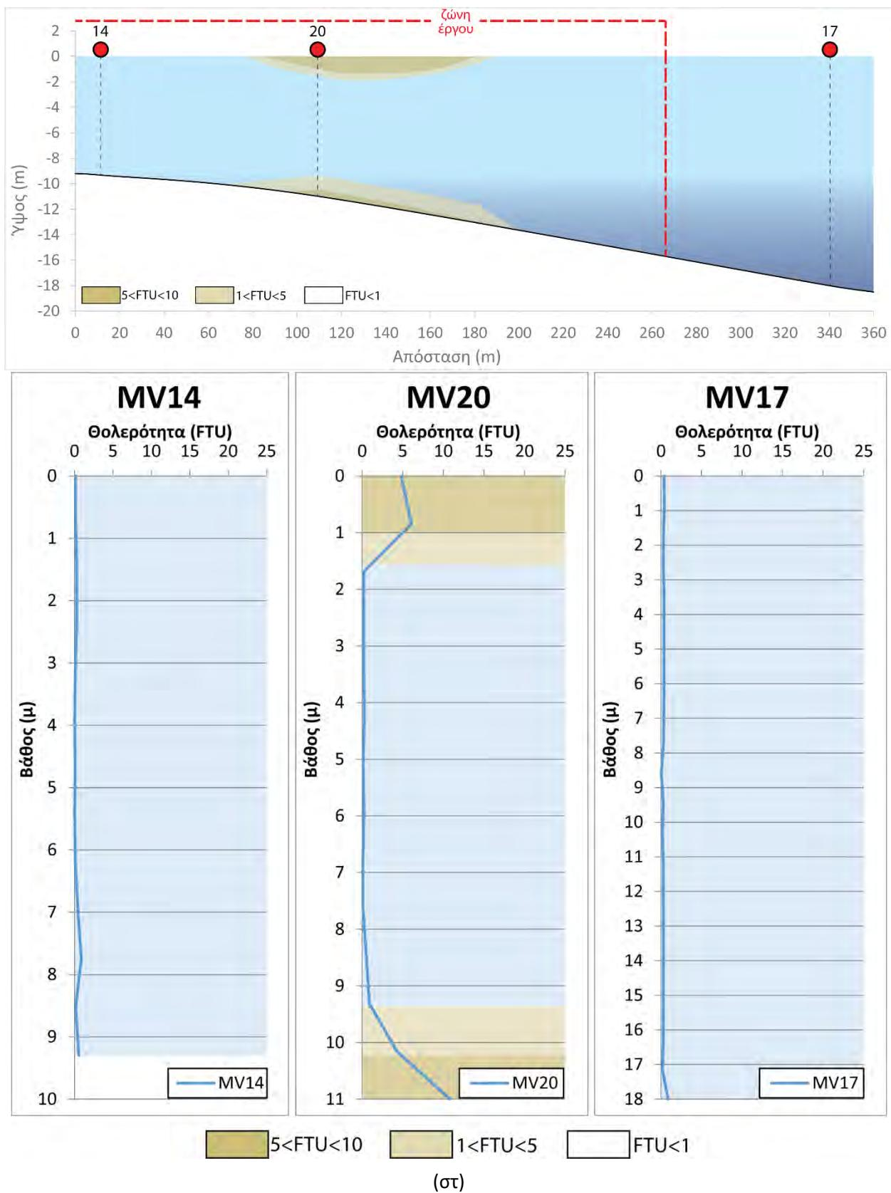
**Εικόνα 6:** Σχηματική αναπαράσταση της διασποράς/διάχυσης του παραγόμενου νεφελώματος από τις εργασίες εκσκαφής/βυθοκόρησης της 11<sup>ης</sup> Φεβρουαρίου 2022. Για τις θέσεις των μετρήσεων βλέπε την Εικόνα 3.
