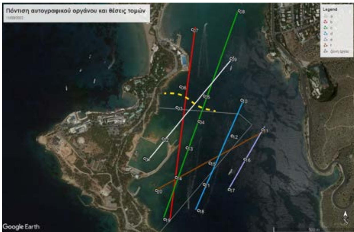
Εικόνα 3: Θέσεις μέτρησης της θολρότητας στην περιοχή του έργου της Μαρίνας Βουλαγμένης κατά τη διάρκεια της 11 ης Μαρτίου 2022. Η άσπρη, η κόκκινη, η πράσινη, η μπλε και η μωβ γραμμή αντιπροσωπεύουν τις γεωγραφικές θέσεις των τομών των Εικόνων 6α, 6β, 6γ, 6δ και 6ε, αντίστοιχα.
