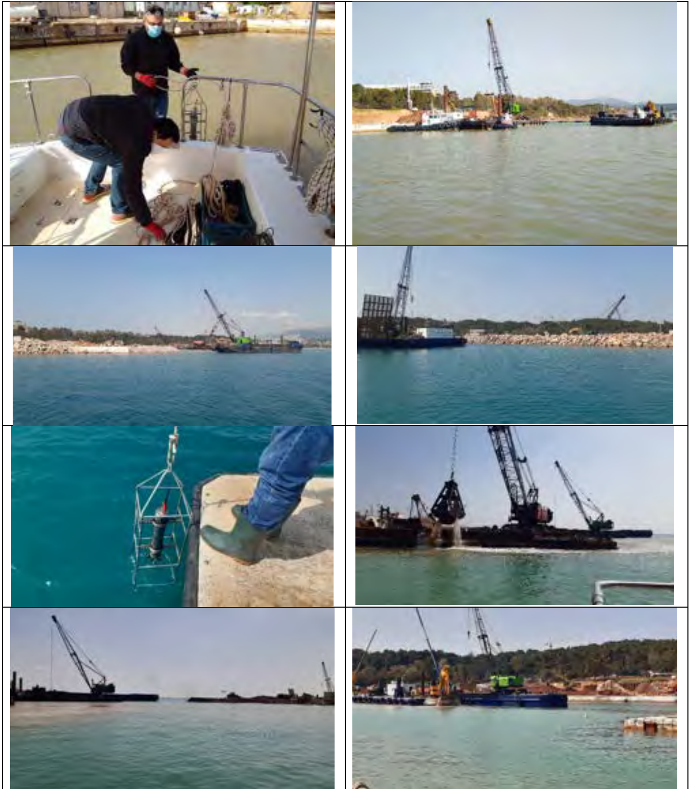
Εικόνα 2: Εργασίες πεδίου με νεφελόμετρο, το οποίο χρησιμοποιήθηκε για τη συλλογή μετρήσεων στην περιοχή του έργου της Μαρίνας Βουλιαγμένης την 17 η Μαρτίου 2022
