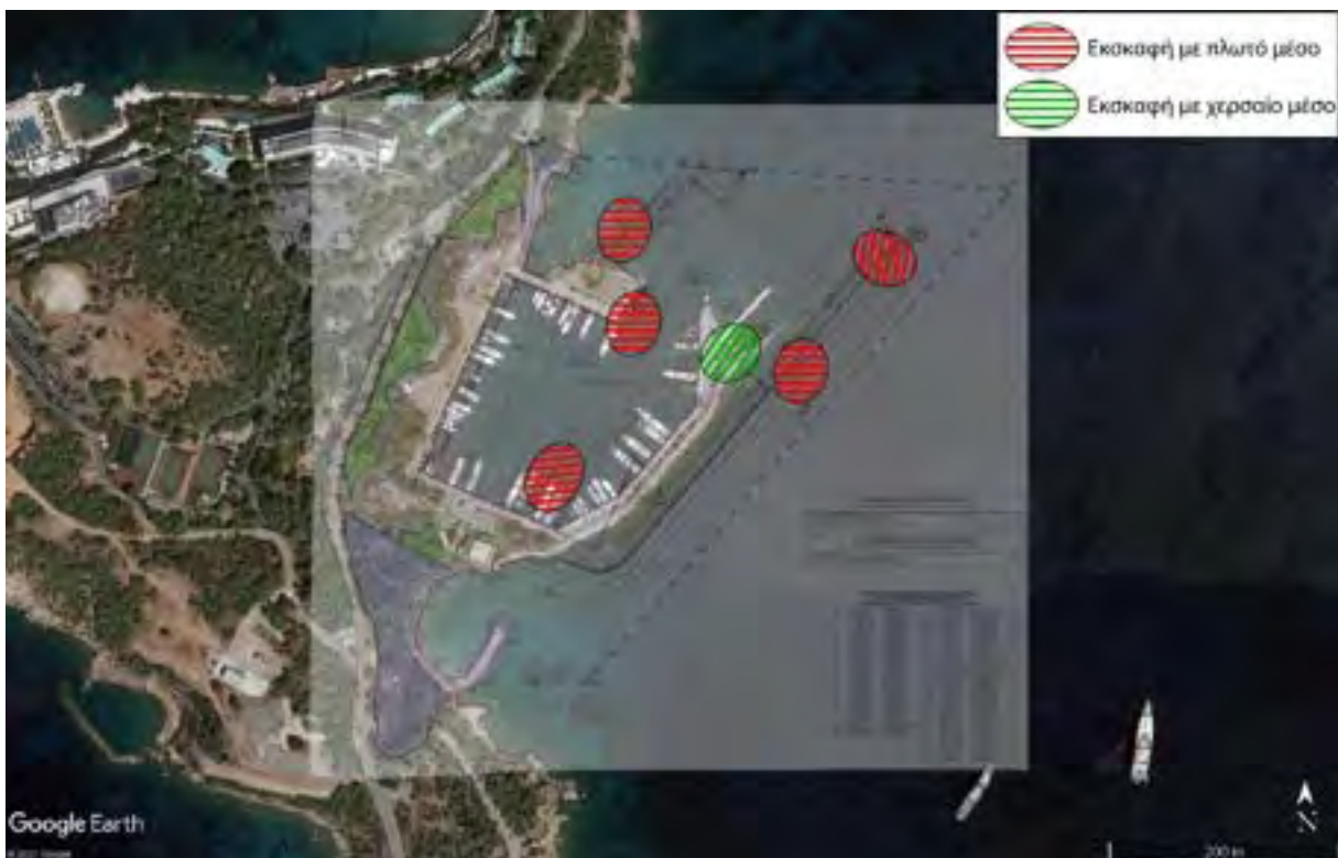
Εικόνα 4: Ενεργές εκσκαφές/βυθοκορήσεις στην περιοχή των έργου της Μαρίνας Βουλιαγμένης κατά τη διάρκεια της 17 ης Μαρτίου 2022.
