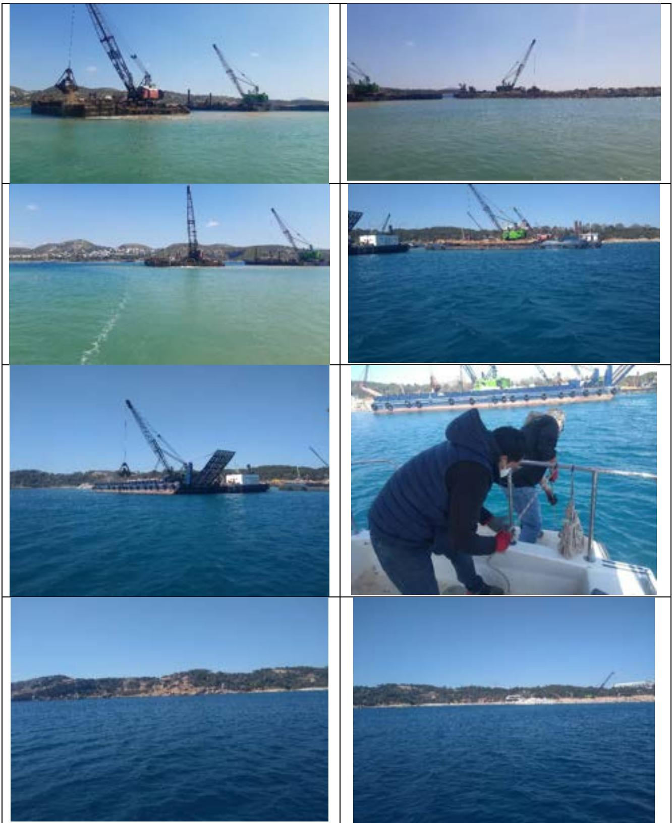
**Εικόνα 2:** Εργασίες πεδίου με νεφελόμετρο, το οποίο χρησιμοποιήθηκε για τη συλλογή μετρήσεων στην περιοχή του έργου της Μαρίνας Βουλιαγμένης την 24<sup>η</sup> Μαρτίου 2022
