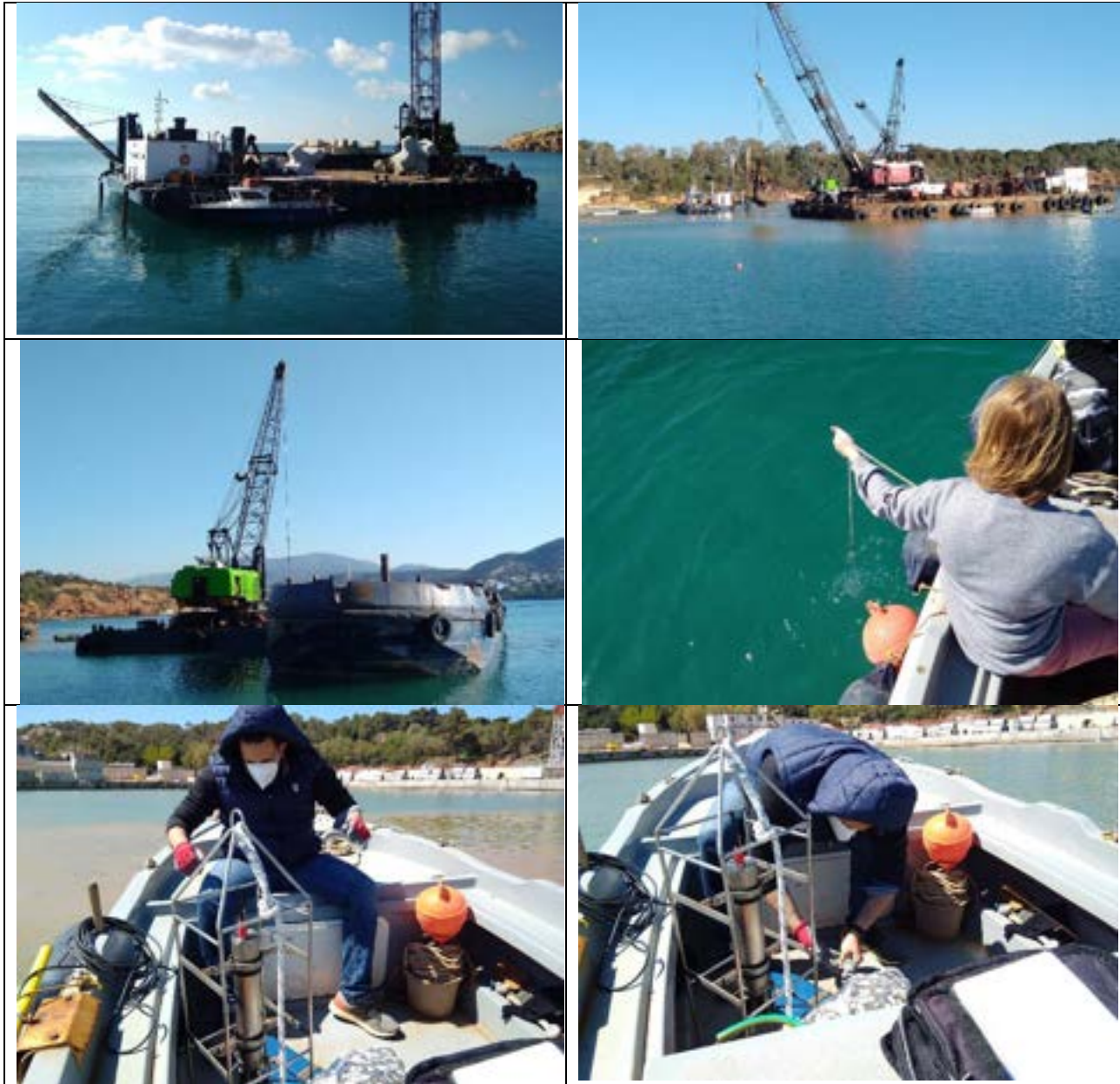
Εικόνα 2: Εργασίες πεδίου με νεφελόμετρο, το οποίο χρησιμοποιήθηκε για τη συλλογή μετρήσεων στην περιοχή του έργου της Μαρίνας Βουλιαγμένης την 20 η Απριλίου 2022
