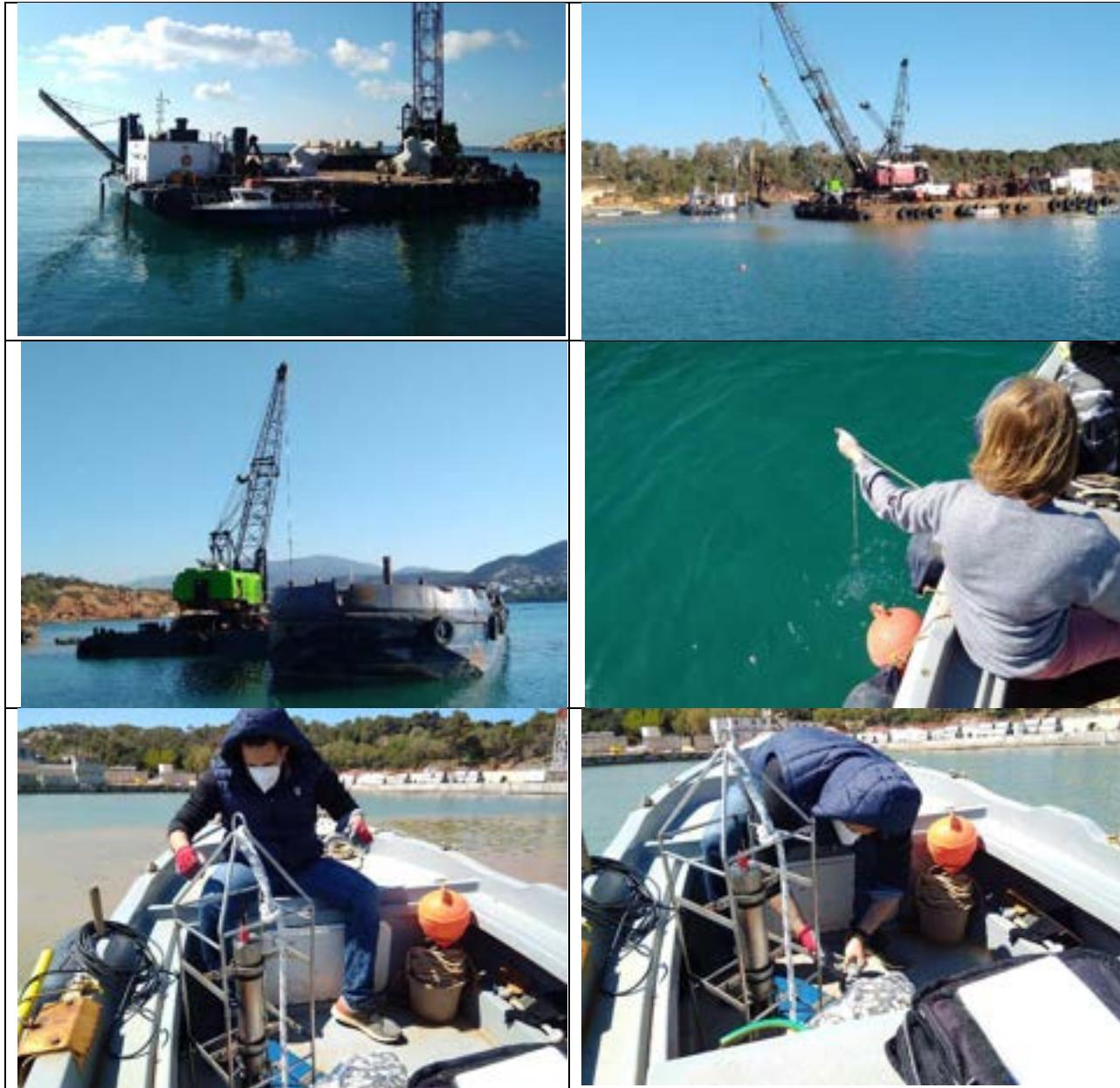
Εικόνα 2: Εργασίες πεδίου με νεφελόμετρο, το οποίο χρησιμοποιήθηκε για τη συλλογή μετρήσεων στην περιοχή του έργου της Μαρίνας Βουλιαγμένης την 20<sup>η</sup> Απριλίου 2022
