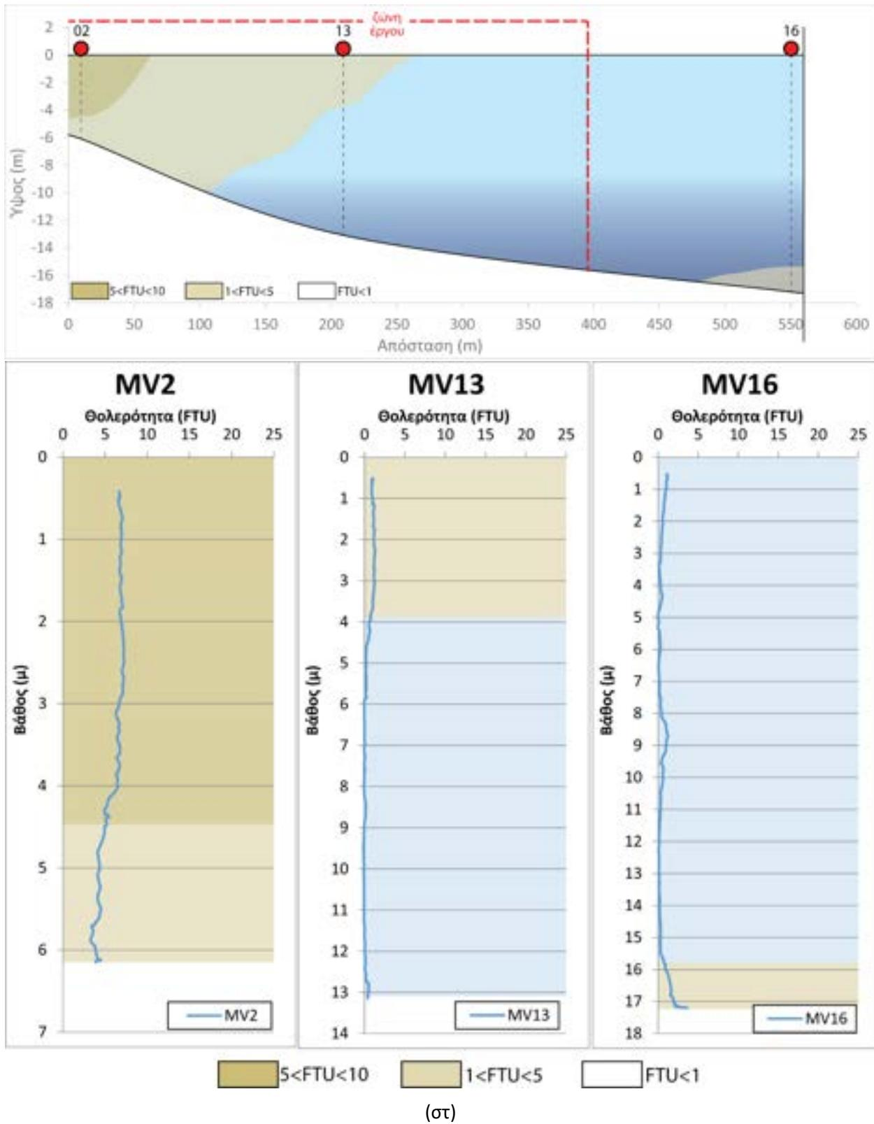
**Εικόνα 6:** Σχηματική αναπαράσταση της διασποράς/διάχυσης του παραγόμενου νεφελώματος από τις εργασίες εκσκαφής/βυθοκόρησης της 23<sup>η</sup> Ιουνίου 2022. Για τις θέσεις των μετρήσεων βλέπε την Εικόνα 3.
